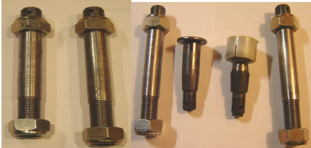
Comparación de los nuevos Pernos con los Originales
